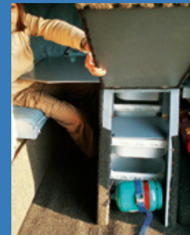
20. Miejsce na butlę gazową.
